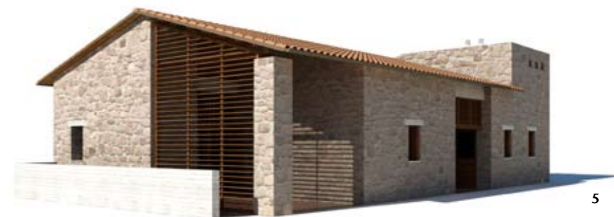
Εικ. 5 Στον αρχιτεκτονικό διαγωνισμό πρότυπων κατοικιών για την αποκατάσταση των πληγέντων από τις εκτεταμένες πυρκαγιές του Αυγούστου 2007 (Βραβείο), μέρος του υπογείου χρησιμοποιείται για τη συλλογή του νερού της βροχής, ενώ παράλληλα οι οπές στον τοίχο στο βάθος του κτιρίου βοηθούν την απαγωγή του αέρα από το εσωτερικό.
